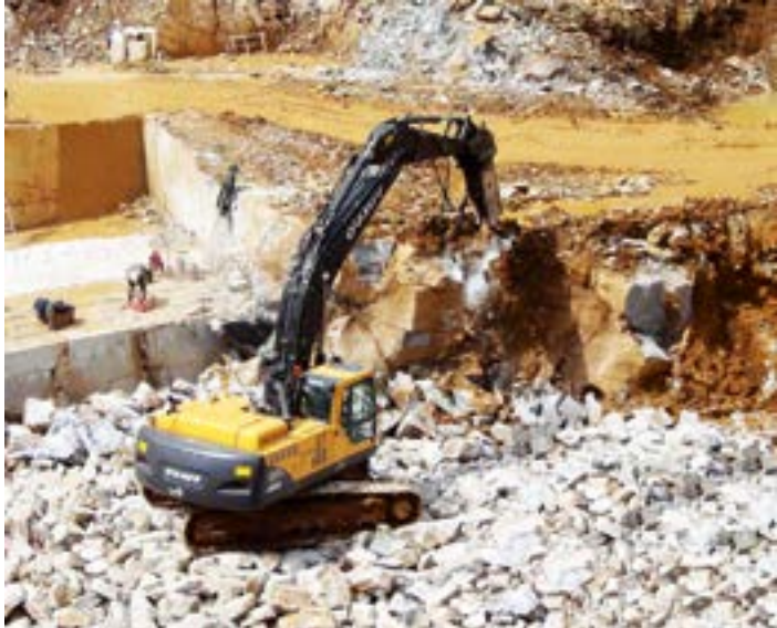
Рис. 3. Разбор отделенного монолита трещиноватых вскрышных пород гидромолотом
